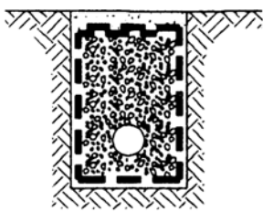
۶- اجرای خاکریز باقیمانده روی کانال و تراکم
